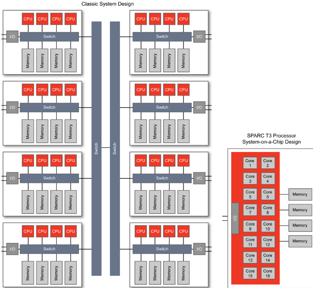
図 4.16 のコアと 128 のスレッドを持つ SPARC T3 プロセッサは、計算能力を最大化すると同時にシステムコンポーネントの数を最小化します。また、さらに多くのプロセッサ、複数のシステムボード、および非常に複雑な設計を持つシステムよりも、優れた信頼性を提供します。
