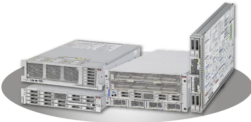
図 2. 最新の SPARC T シリーズファミリー (オラクルの SPARC T3-1B ブレードサーバー、SPARC T3-1 サーバー、SPARC T3-2 サーバー、SPARC T3-4 サーバー) には高度な RAS 機能があり、IP サービス稼働時間を最大化します。
