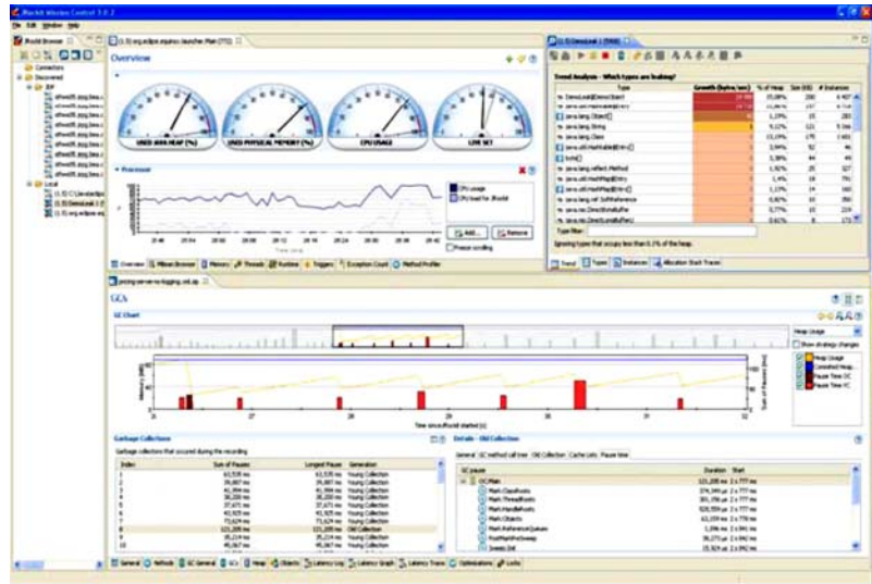
図 2. 非侵入型で低オーバーヘッドのテクノロジーにより、Oracle JRockit Mission Control は JVM 環境をリアルタイムで監視/診断
