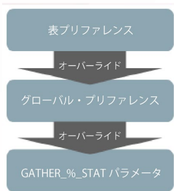
図2：DBMS_STATSプリファレンスであるPREFERENCE_OVERRIDES_PARAMETERの使用
