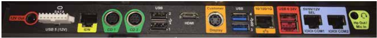
Abbildung 2: Die Oracle MICROS Workstation 6 Family unterstützt eine große Anzahl an Peripheriegeräten. Die Abbildung zeigt das I/O-Panel des Modells 620/650.
