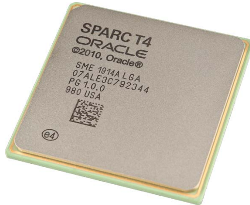
図 1：8 コアで最大 64 スレッドを同時並列処理することにより、前世代のプロセッサとの比較でシングルスレッド性能が 5 倍に向上した SPARC T4 プロセッサ
