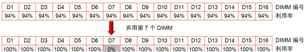
图 2. DIMM 热备在不中断服务的情况下提供单个 DIMM 的自动故障切换。
