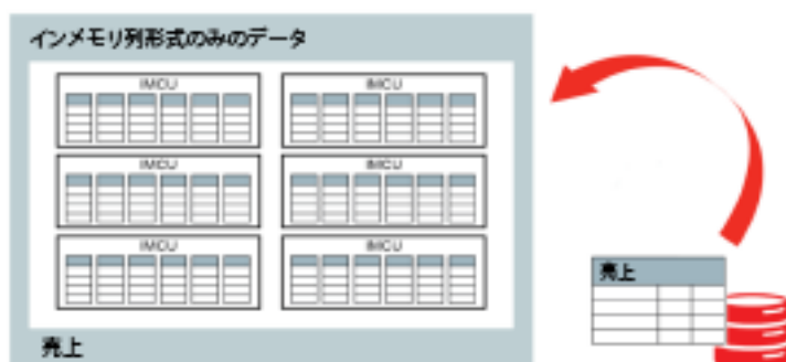
図4：インメモリ列形式データがより小さなIMCUに断片化されるため、並列処理が可能
