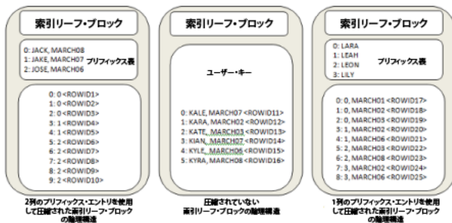
図2：高度な索引圧縮を使った索引リーフ・ブロックの論理構造
