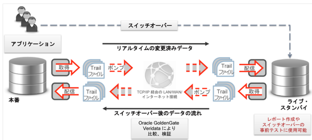
図13.Oracle GoldenGateは計画外停止の発生時に堅牢なフェイルオーバー・ソリューションを提供します。
