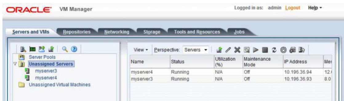
図21 : 検出後、すべてのOracle VM ServerがUnassigned Serversフォルダに表示されます
