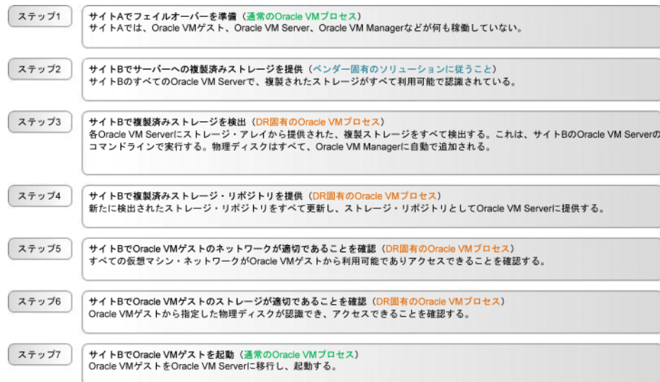
図29：サイトAからサイトBへのフェイルオーバーを達成するためのプロセス・フロー
