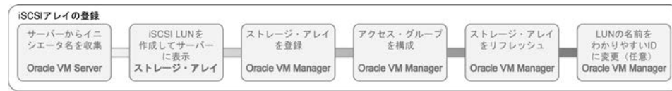
図62: iSCSIストレージ・アレイを登録するプロセス・フロー
