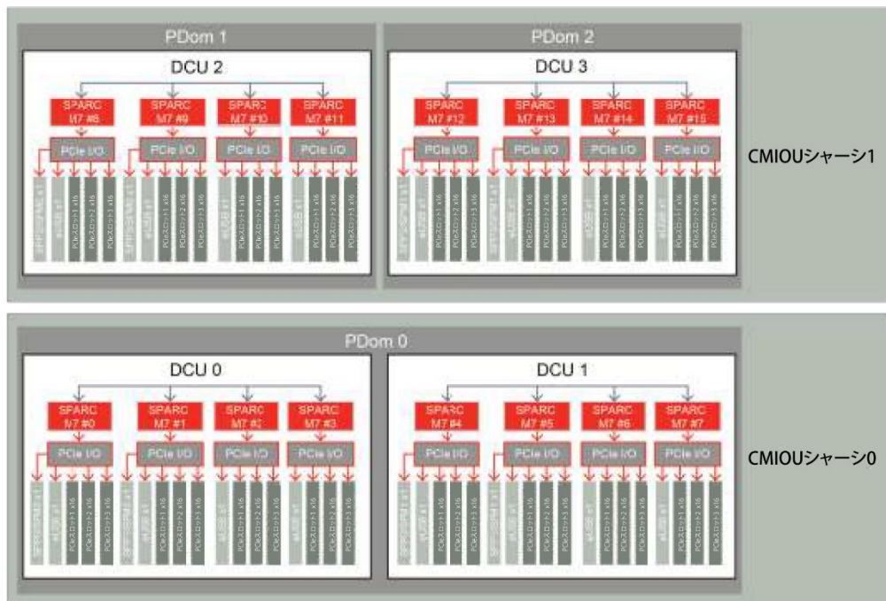
図22： 4つのドメイン構成ユニット（DCU）に分割されたSPARC M7-16サーバー。このDCUを柔軟に組み合わせ、1～4のPDomを作成可能（図では3つのPDomを表示）
