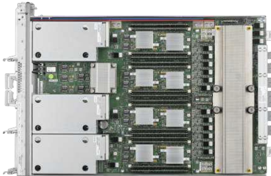
図15：各CMIOUボードには、1基のSPARC M7プロセッサ、16個のDDR4 DIMMスロット、I/OコントローラASIC、および3つのPCIe x16ホット・プラグ対応カード・キャリアが含まれる
