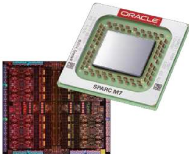
図2：SPARC M7プロセッサは、32個のSPARC S4コアとSoftware in Silicon機能を組み合わせて、アプリケーションとデータベースのパフォーマンスを加速
