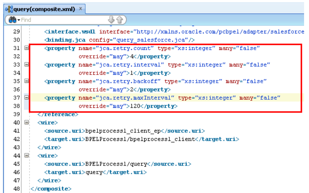
図 7-2 composite.xml ファイルのプロパティ
