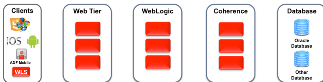
図1：Oracle WebLogic Suite本番環境の一般的なデプロイメント・トポロジ
