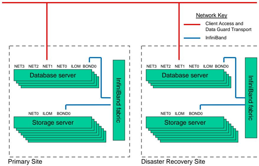
FIGURE 1, DATA GUARD NETWORK CONFIGURATION
