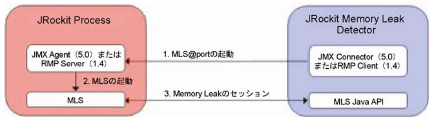
図 8 : Memleak セッションの確立
